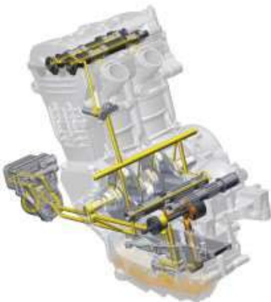
Bild 4: Ölkreislauf Figure 4: Lubrication system
