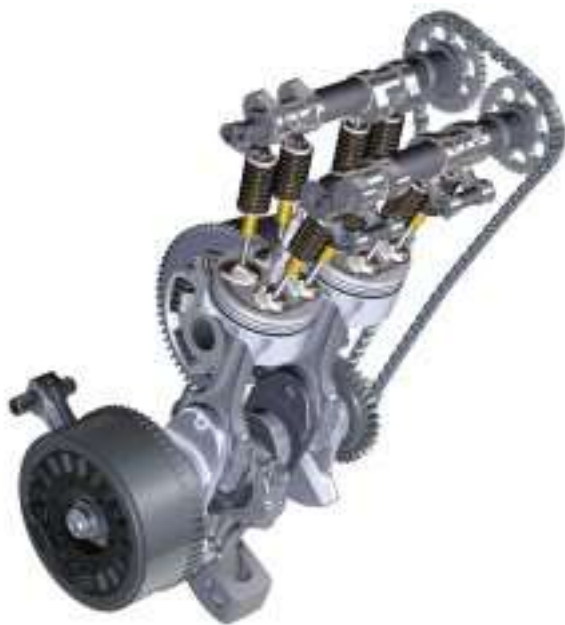
Bild 3: Steuertrieb Figure 3: Valve train
